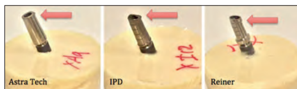
Figura 3 Deformación de los pilares tras el ensayo de carga.
